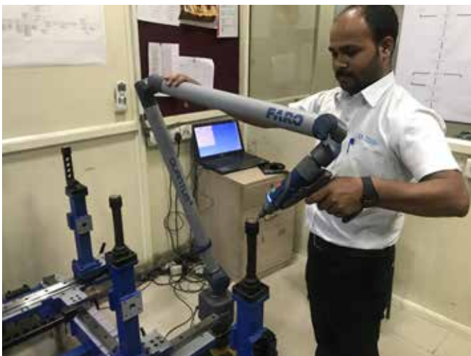
FaroArmにより、以前は届かなかった箇所も検査できるようになり、高品質治具の作成のために信頼性の高い精度を実現できるようになった。
