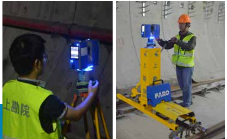
左图:静态自由设站扫描。 右图:移动三维扫描。
