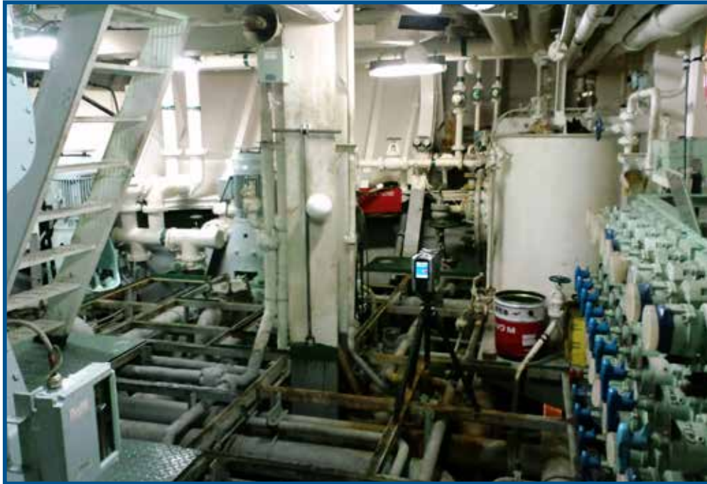
ファローレーザースキャナー・フォーカス 3D による機関室のスキャンニング
