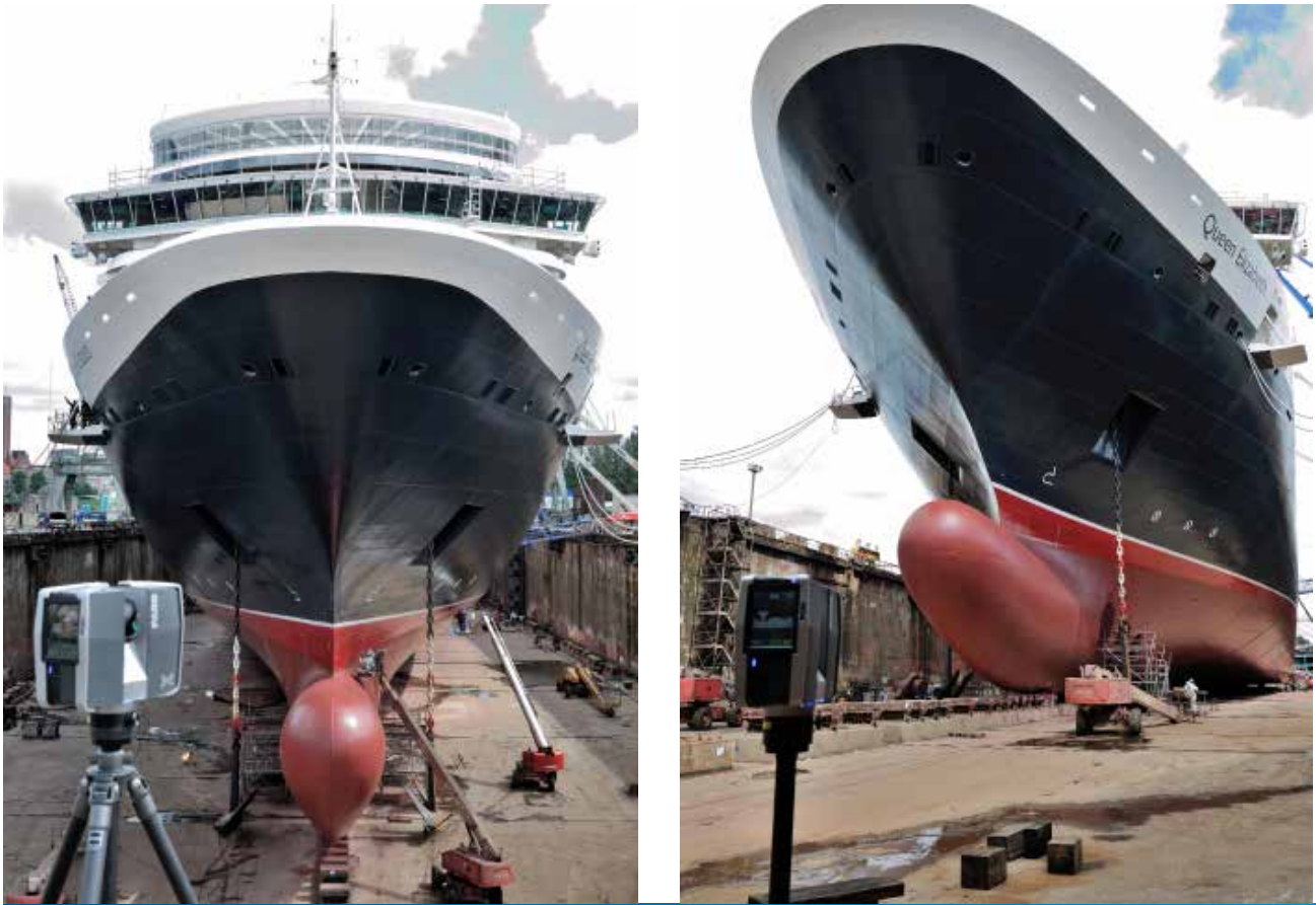
FAROレーザー扫描仪Focus 3D は、船全体をすべての側面からスキャンすることが可能。
