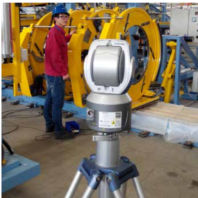
FARO Laser Tracker Vantageが機械の穴位置を測定します。
