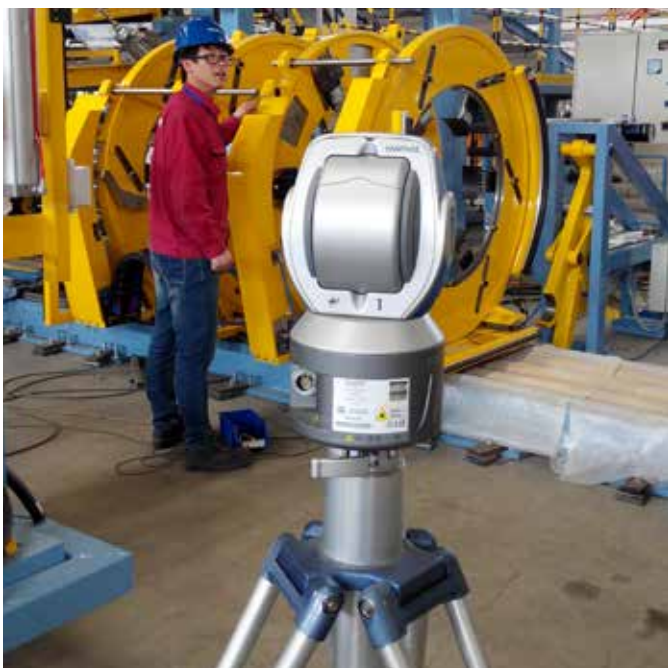
FARO Laser Tracker Vantage 检测设备定位孔。
