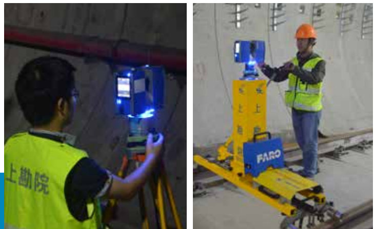
固定した状態でのスキャン（左）と、可動装置に FARO Laser Scanner Focus 3D X 330を取り付けたモバイルスキャン（右）。
