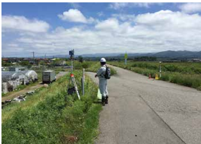
Focus 3D にて堤防の計測を行うことで、 草の裏にある地盤高を正確に求めることが可能。
