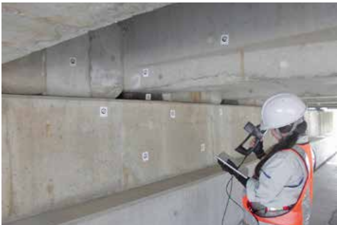
橋桁や橋台など大きな構造物はFocus 3D で計測（上）。 支承周りなど細かい部分はハンディスキヤナFreestyle 3D Xで計測（下）。
