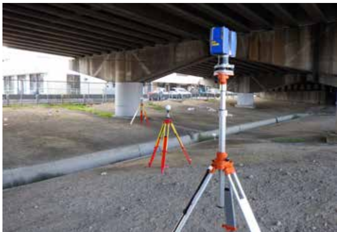
Focus 3D X 330と複数のマーカーを設置し、現場周辺を一気に点群データ化
