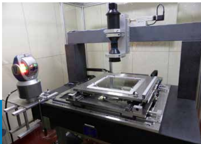
上海天文台のスキヤナの測定。古い星の写真から星の座標を読み取るスキヤナは、高い精度が求められ、スキヤナの軌道を計測するためにLaser Trackerが重要な役割を果たしました。
