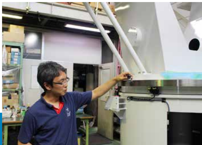
JAXAから依頼された望遠鏡のフレームの真円度を Laser Trackerで測定する大谷氏。
