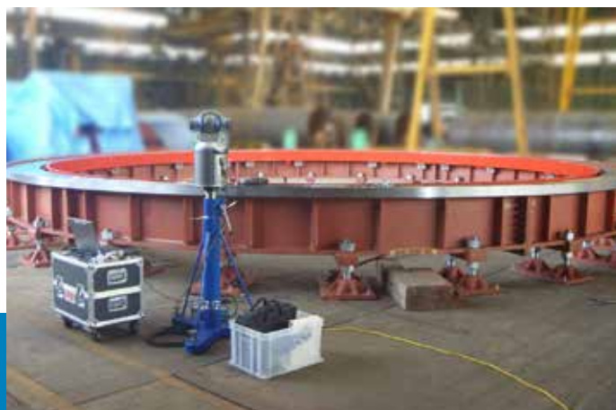
TAO望遠鏡のベースの測定。外周部分は直径12mもあり、上面の偏差は0.05mm。
