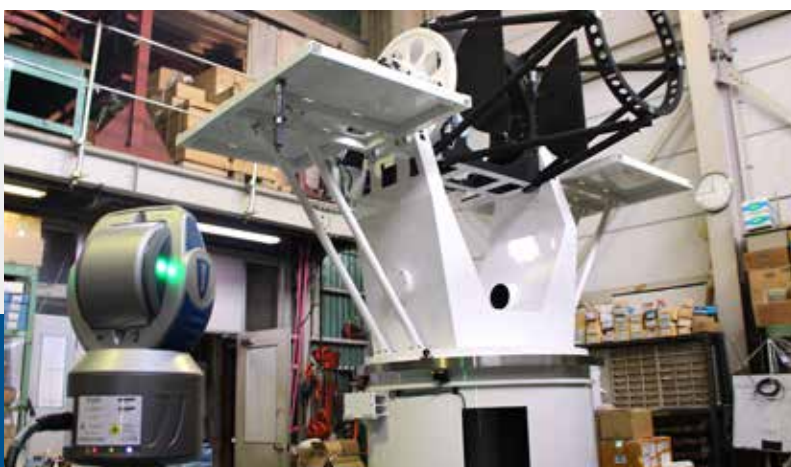
高い組立精度を実現するFARO Laser Tracker™
