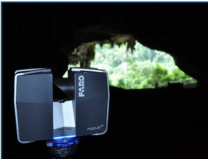
コンパクトでポータブルな FARO レーザースキャナー Focus 3D は、パソコンがなくてもスキャン可能
