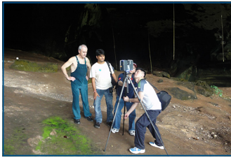
(左) レーザースキャナーのセットアップ (右) データ位置合わせのため基準球を使って洞窟をスキャンする Focus 3D
