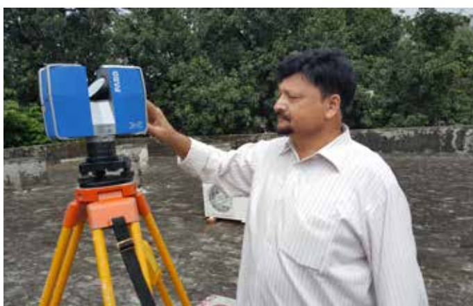
一位研究人员正在使用Focus 3D 扫描铁路基础设施。
