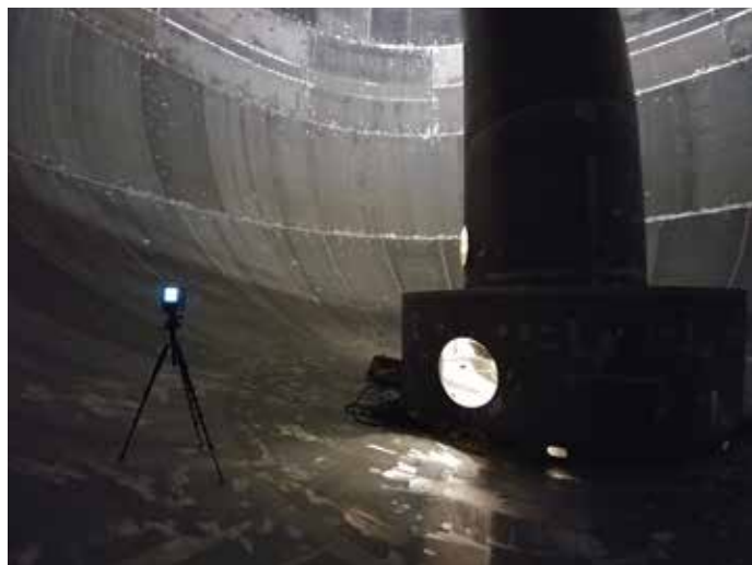
FARO Focus 3D X 330を使用し、タンカーの貨物倉内部をスキャン中。
