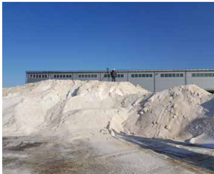
FARO Focus 3D を使い、Intertekは、オープンヤードに散在する乾物のバルク貨物の正確な容量計測を実現。
