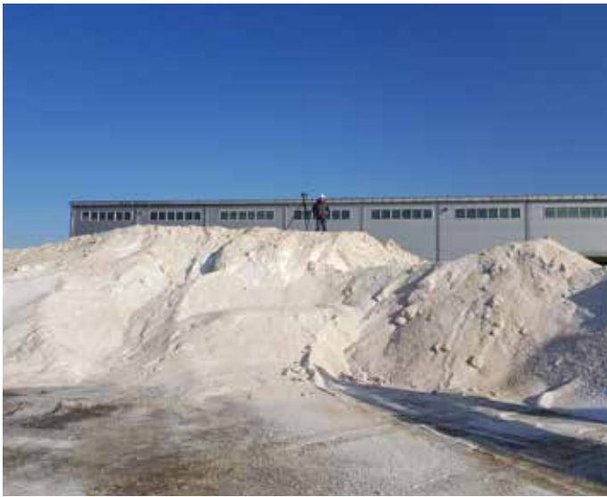
使用 Focus 3D ，Intertek 可以测量散放在露天场地上的干散货的确切体积。
