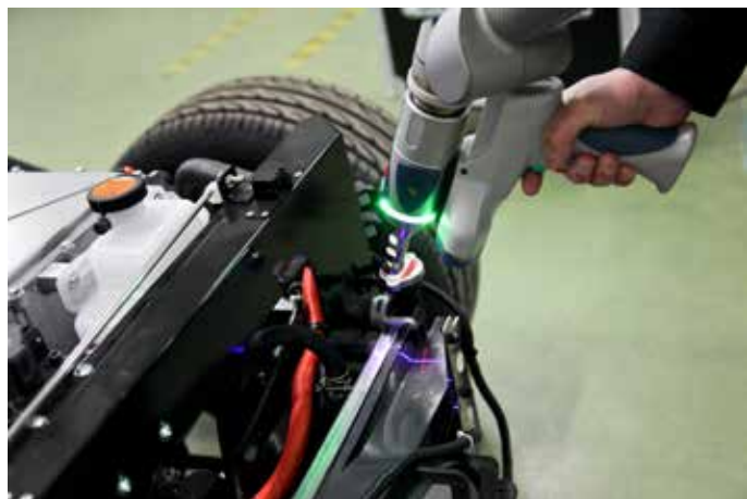
FARO Edge ScanArm HDでEV車のプラットフォームを測定。
