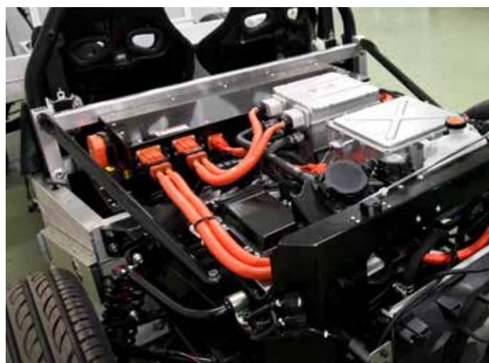
シャシー上に部品がコンパクトに収まったEV車のプラットフォーム。
