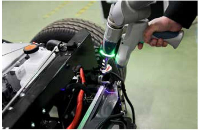
使用 FARO Edge ScanArm HD 测量电动汽车平台。
