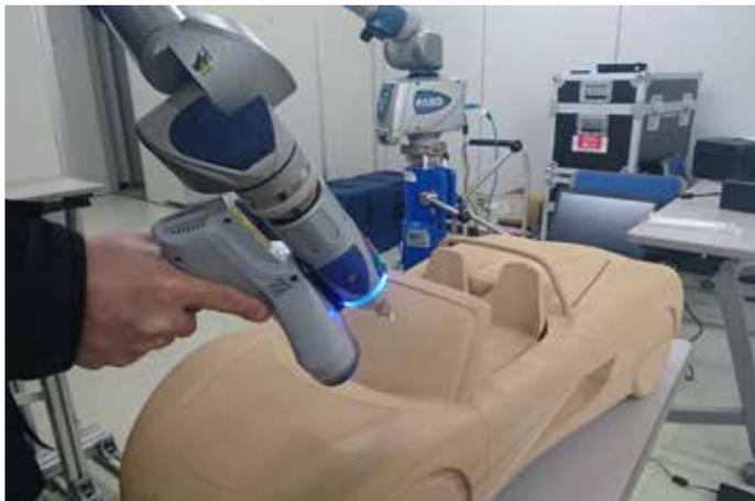
扫描模型，该模型将被用于电动汽车的实际开发。
