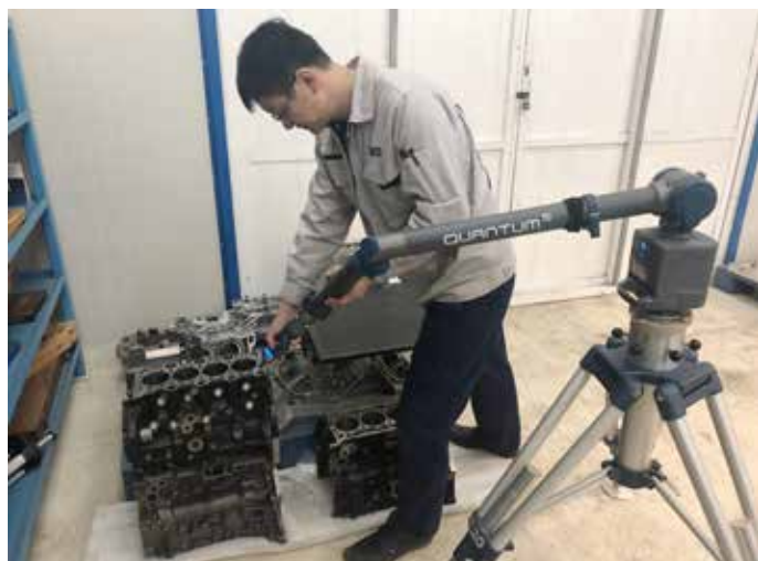
FaroArmで初回品検査を実施。
