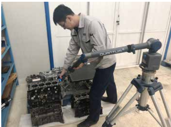
用 FARO 测量臂进行首件检测。
