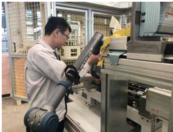
在生产线上进行检测的 FARO 测量臂。
