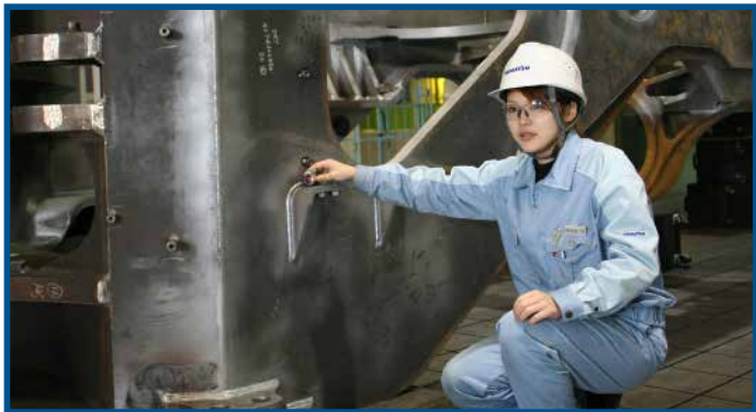
穴位置などもターゲットを接触させるだけで測定
