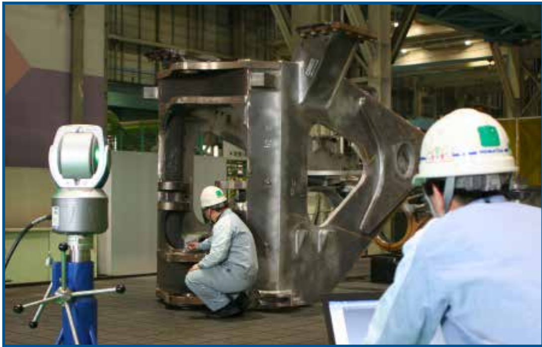
FARO Laser Tracker Vantage での大型部品の測定
