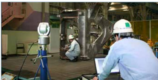
使用 FARO Laser Tracker Vantage 测量大型部件
