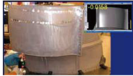
FaroArm を使って CAD モデルからエンジンカバーのためのトリムラインを製作
