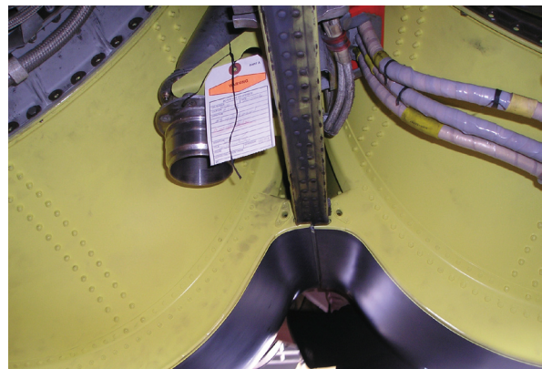
FaroArm を使ってバイパスダクトが製作された状態。接合点は正しく並んでいることがわかる。
