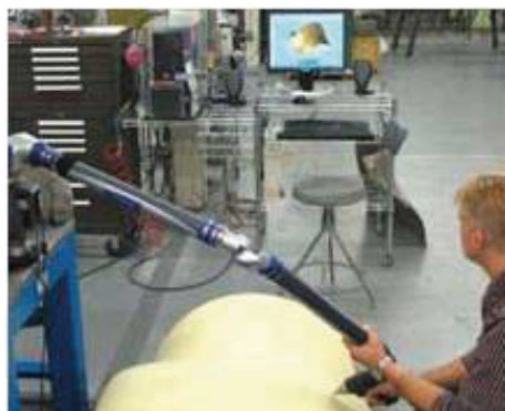
CAD を使ってオリジナルのマスターモデルをリバースエンジニアリング
