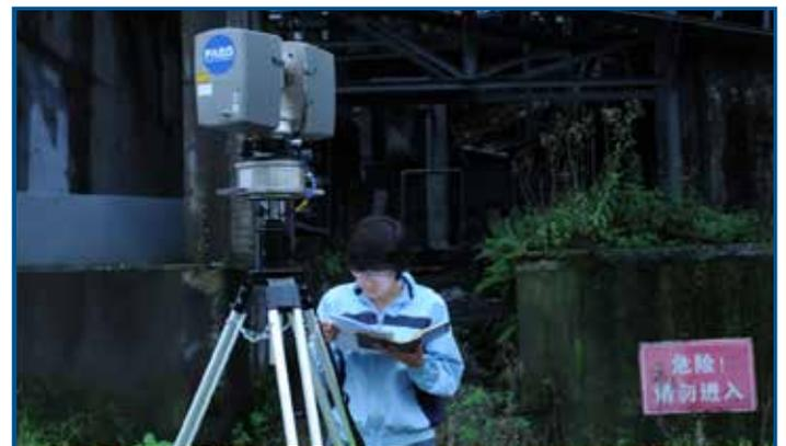
FARO Laser Scanner Photon 120 为汶川穿心店地震遗址公园提供高速及高精度扫描功能。
