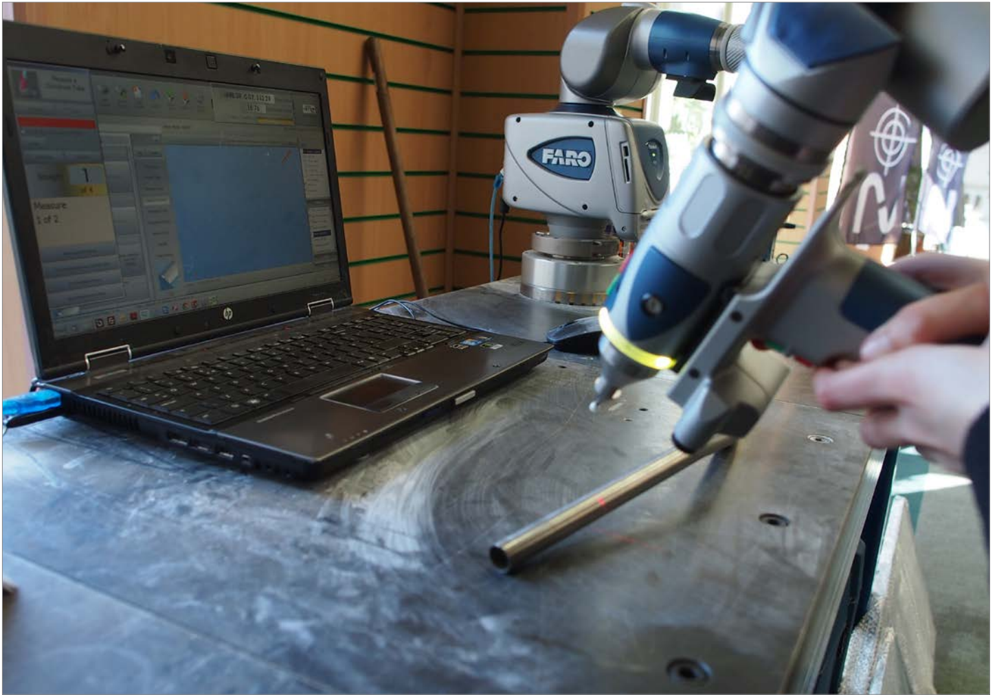
Mesures tactiles et sans contact de tubes afin d'obtenir des représentations 3D détaillées et de haute précision des tubes.
