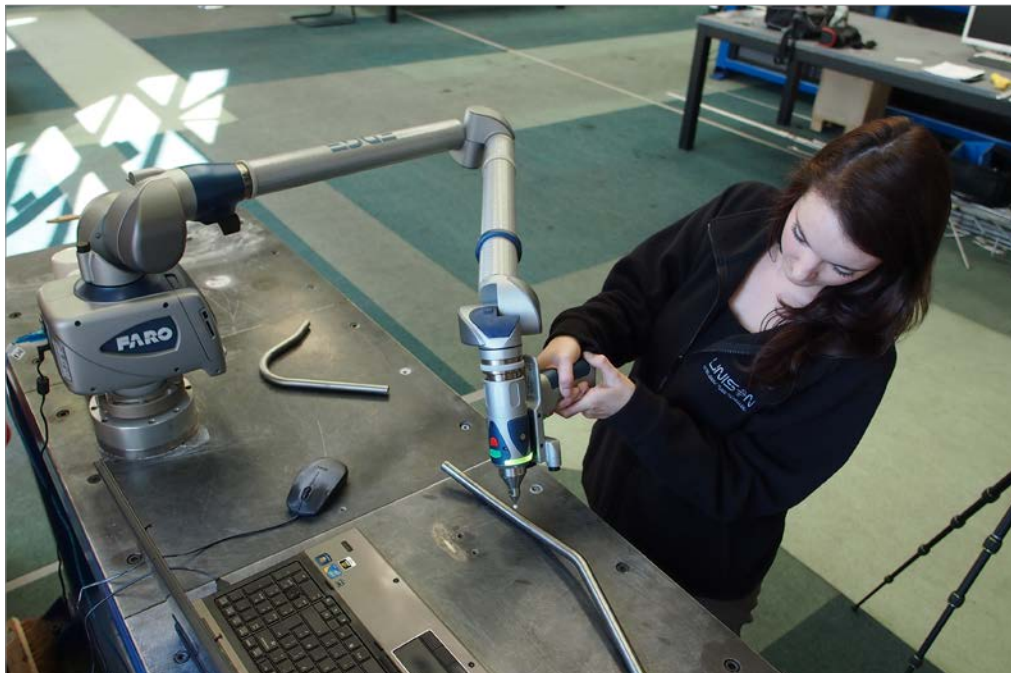
Mesure avec et sans contact de tubes afin d'obtenir des données 3D détaillées et précises.
