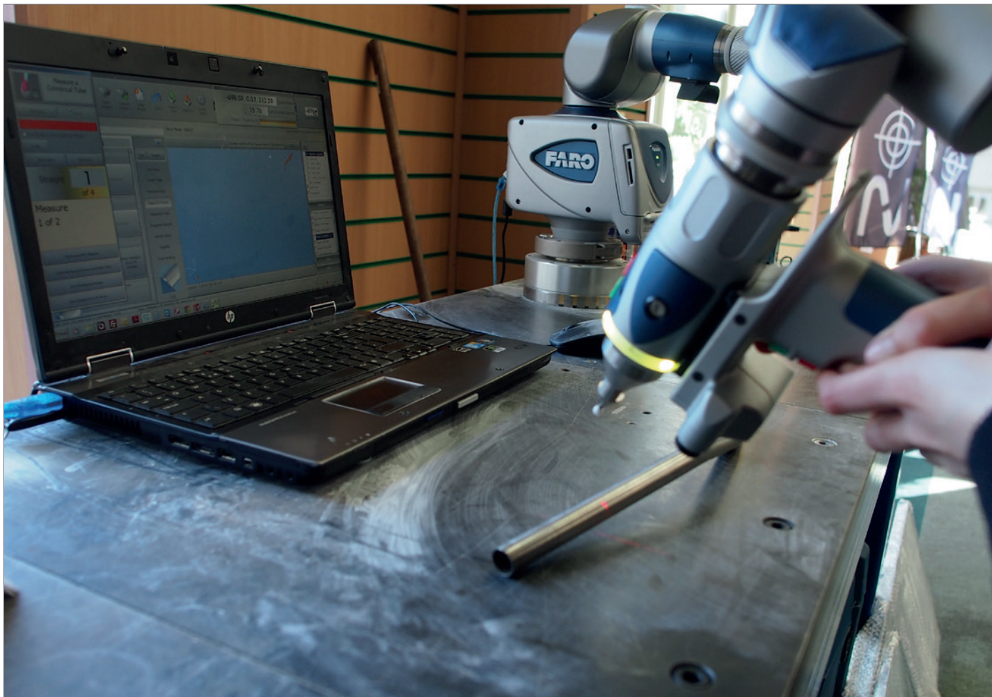
Taktile und berührungslose Vermessung von Rohren, um detaillierte und hochpräzise 3D-Darstellungen zu erzielen.
