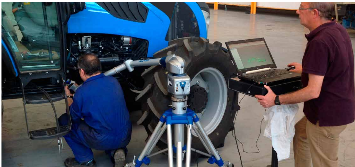
Le bras de mesure FARO Edge ScanArm ES employé par Tenías dans le cadre de l'assurance qualité
