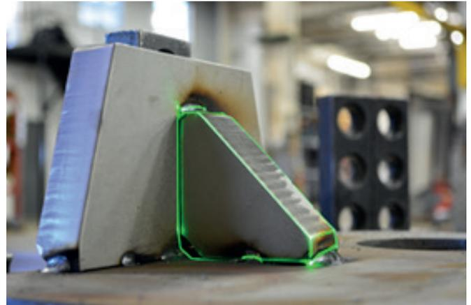
Die Laserprojektionen des Tracer führen den Bediener der Reihe nach durch die einzelnen Projektphasen und zeigen, wo die jeweiligen Teile oder Komponenten platziert werden sollen.
