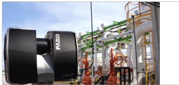
Abb. 3: Erfassung komplexer Rohrleitungsstrukturen mit einem Laserscanner
