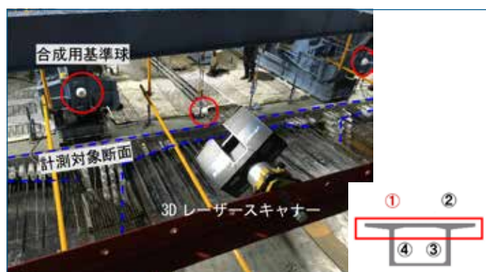
桥梁上方的点云测量。横向安装 Focus S 350、并设置靶球用于合成点云数据。
