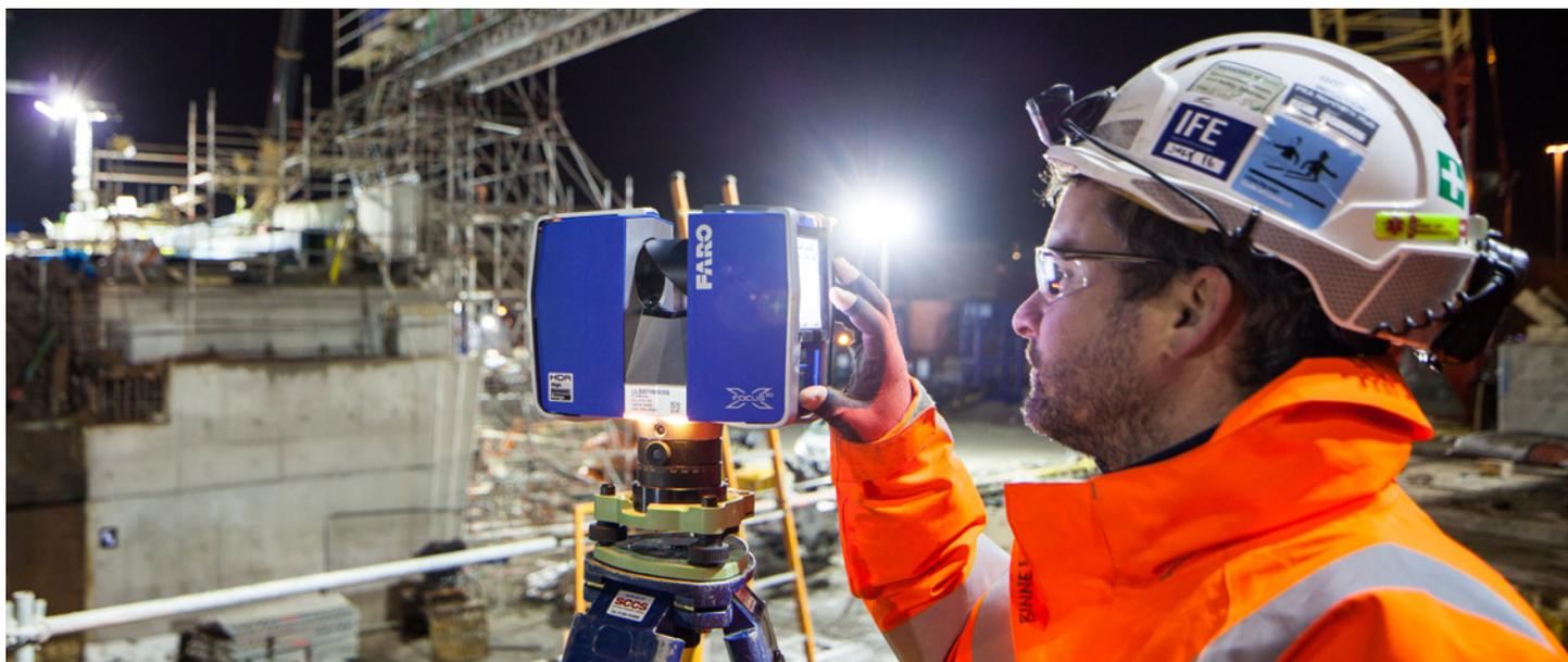
CAM2 Focus<sup>3D</sup> X330 è utilizzato in svariate attività di preparazione quali il riallineamento di binari esistenti, la costruzione di nuovi ponti, la rimozione di archi in disuso
