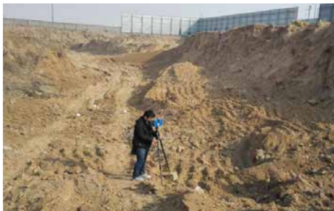
現場地形スキャニングにFAROのFocus 3D を使用。
