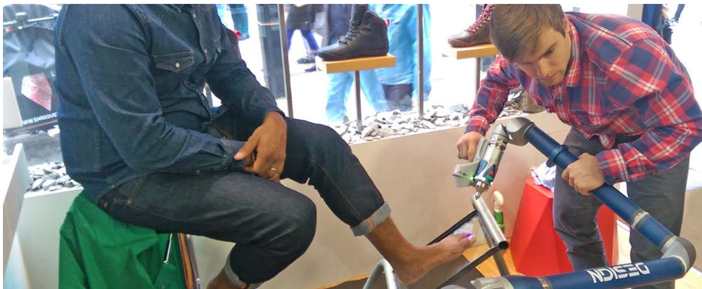
Création de l'image numérique d'un pied avec le FARO Design ScanArm.
