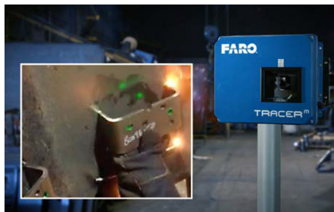
Illustration 4. Déploiement dans un atelier de soudure. Le projecteur Tracer M est suffisamment robuste pour être déployé dans la zone de production grâce à son boîtier étanche à la poussière.
