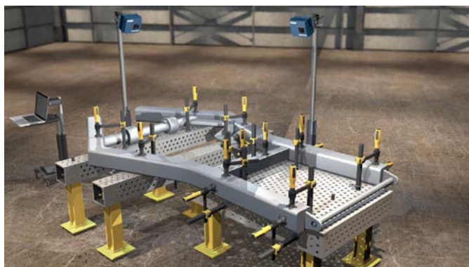
Figure 3. Deux projecteurs Tracer M lors d'une opération d'assemblage.
