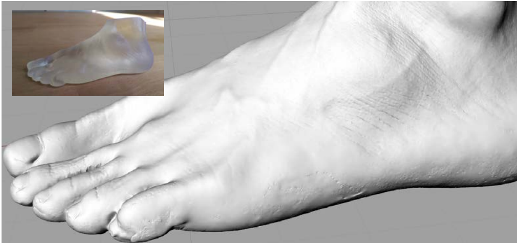
Scan eines Fußes, der mit dem Design Scan Arm erzeugt wurde.
