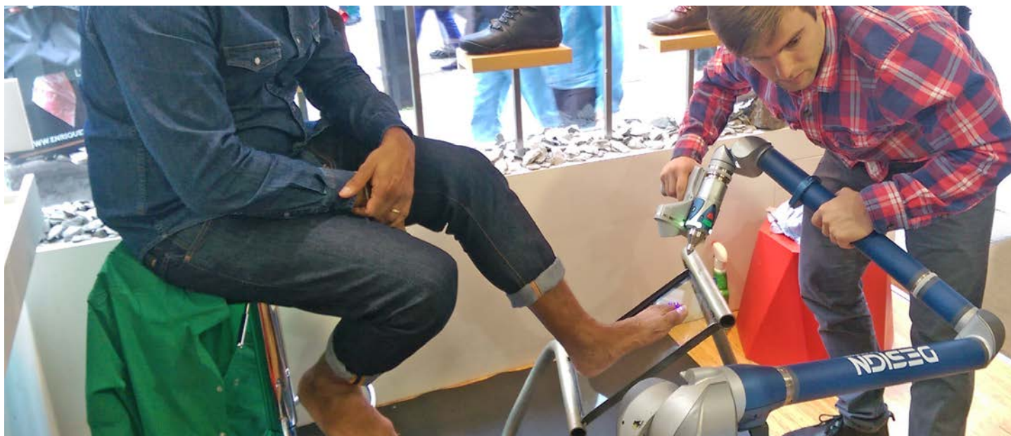
Scannen eines menschlichen Fußes mit dem FARO Design ScanArm.
