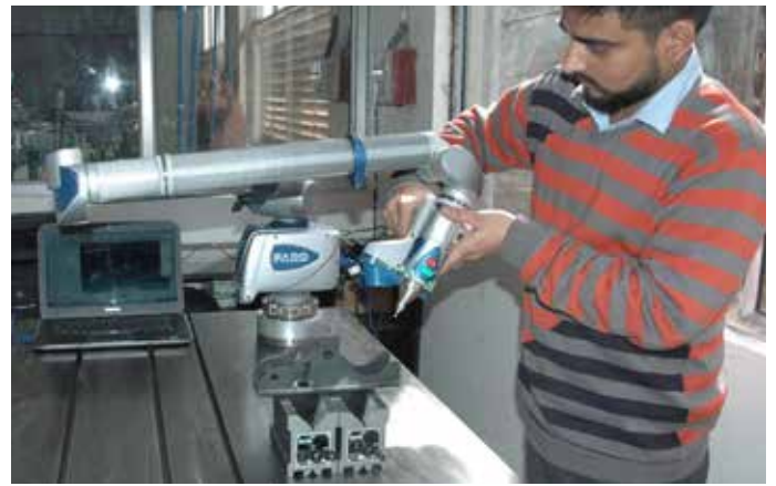
一位员工演示如何使用FARO Edge ScanArm® HD来检测产品。
