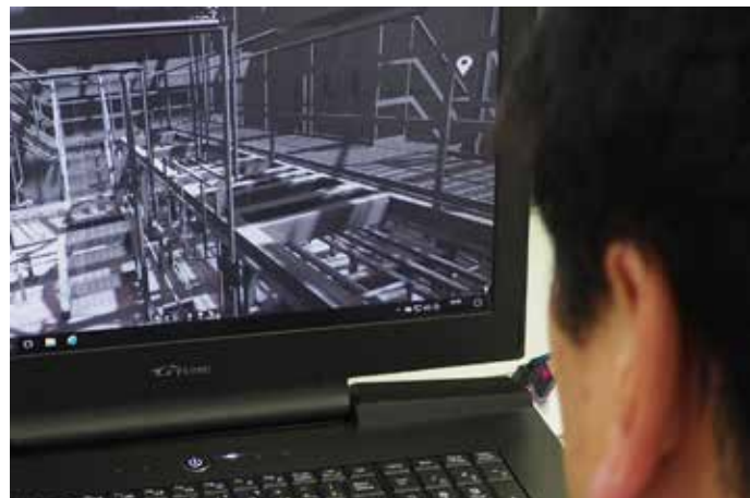
Focus 3D X 130で計測した点群データをもとに作成した既存プラントの3Dモデル。
