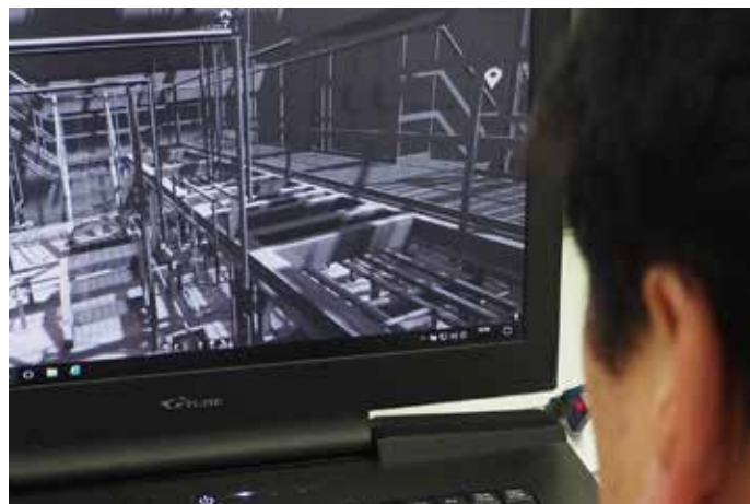
一名技术人员正在处理利用 Focus 3D X 130 获取的点云数据所创建的三维模型。
