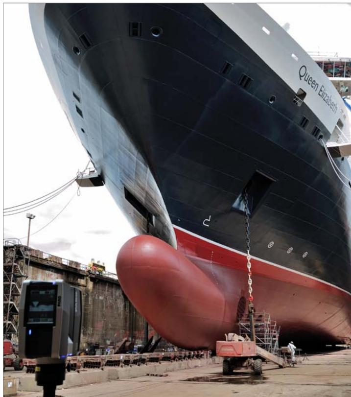
Mit dem FARO Laser Scanner Focus<sup>3D</sup> konnte der gesamte Rumpf aus allen Perspektiven gescannt werden.
