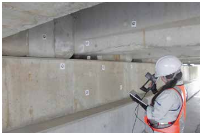
操作员使用轻巧的 Freestyle 3D X 获得周围区域的详细扫描（例如桥梁支撑梁）。
