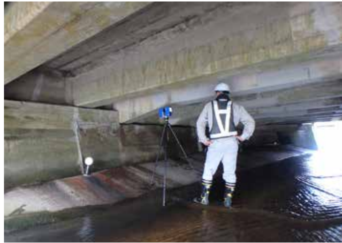
Focus 3D X 330 轻松扫描桥梁和桥墩等大型结构。
