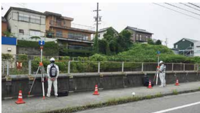
操作员使用 Focus 3D X 330 收集点云数据。
