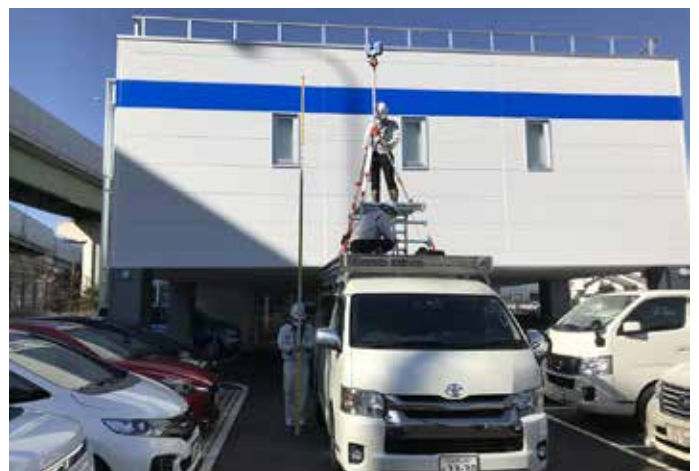
堆叠在车辆顶部的定制脚手架使得 Okumura Sekkei 能够从高处（6 米）以较少次数的扫描获得大型结构的数据。
