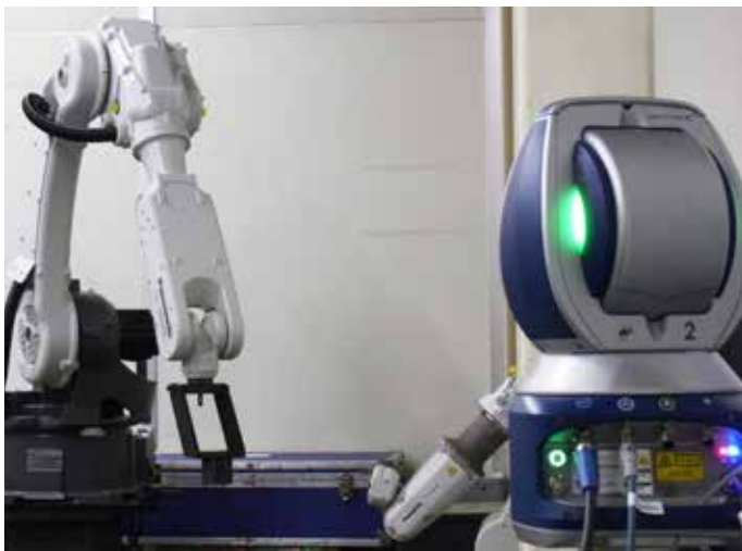
FARO Laser Tracker Vantage 配合 BuildIT Metrology 软件准确测量机械手臂的运动轨迹。
