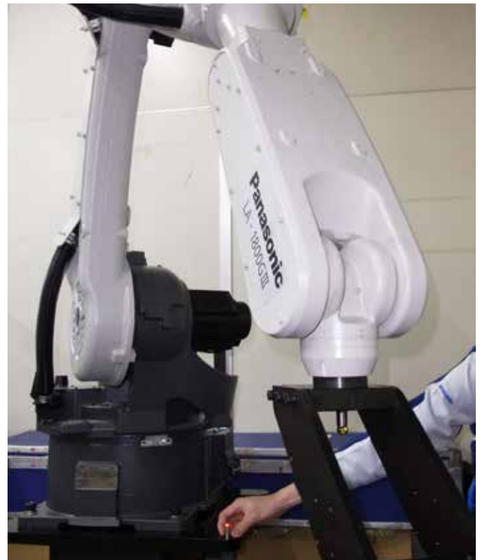
用附带用于测量标记的传感器SMR(反射靶球)对中型多功能机器人机械手LA-800基座进行测量。
