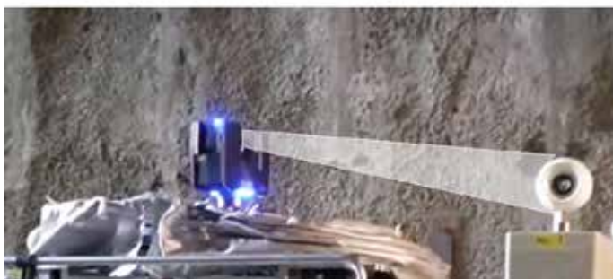
标记物具有内置棱镜，用于与全站仪（顶部）进行坐标定位。Focus 3D 指向标记物的圆形表面，以进行点云测量（底部）。
