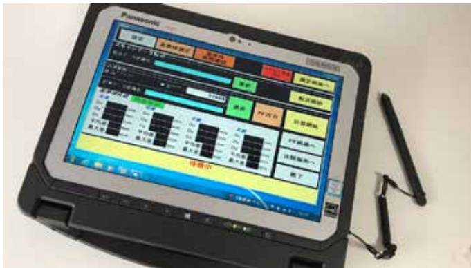
システムのコントローラーとなる工事現場用タブレットパソコン。
