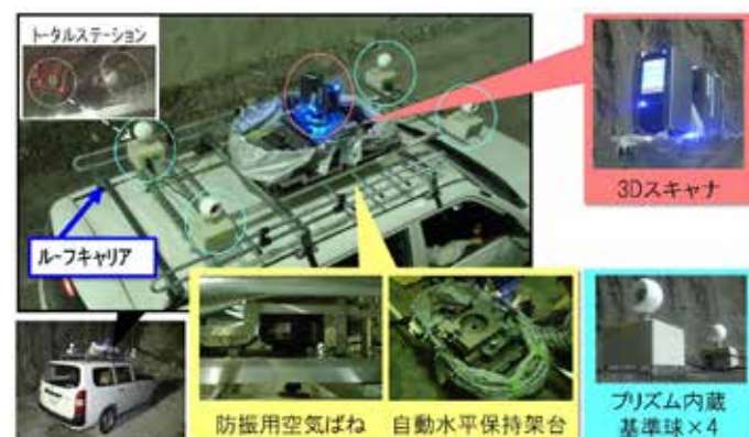
ワゴン車の屋根上に搭載されたFocus 3D や自動水平保持金具など。
