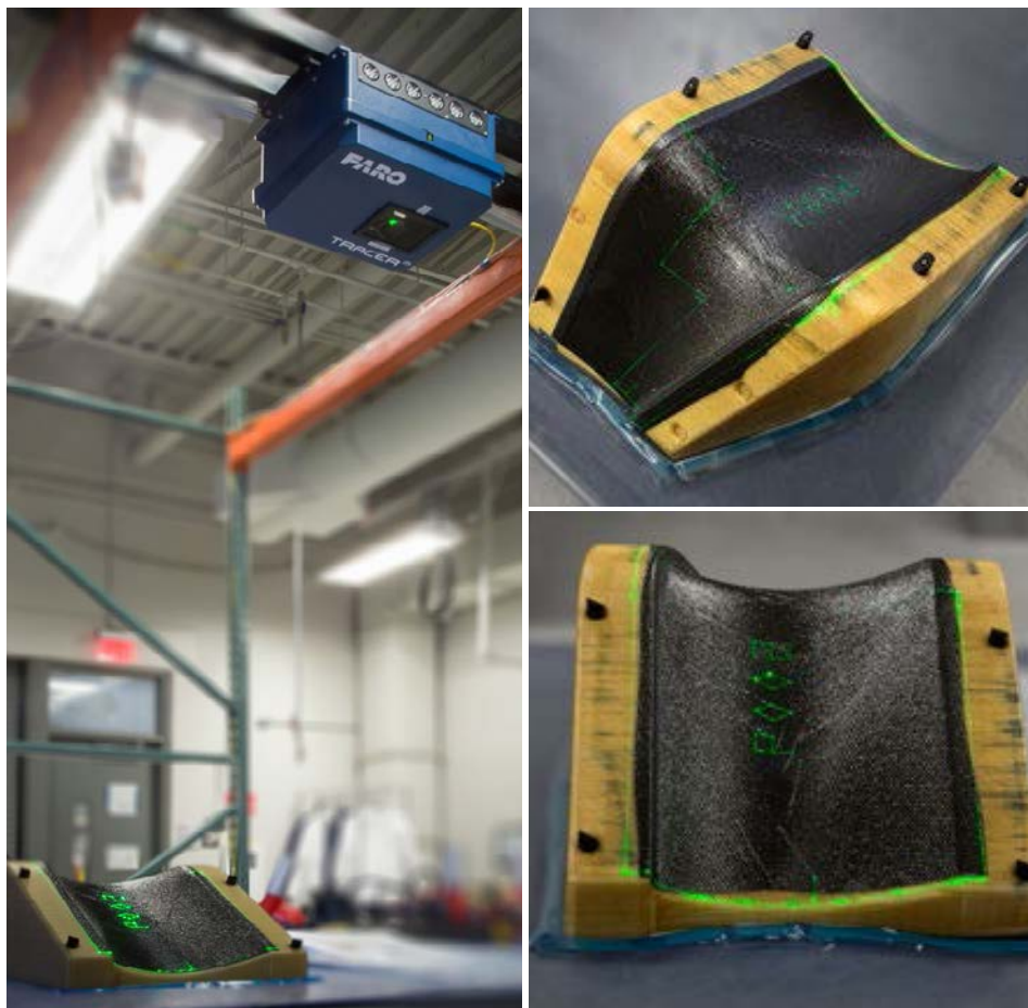
Proiezione di un Tracer ® sullo stampo di un'aletta per la laminazione con ausilio di laser in un impianto di assemblaggio di materiali compositi.
