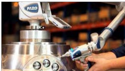
7-achsiger Arm mit rotierendem „Handgelenk“
