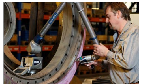
Dimensionsanalyse mit einem Gelenkarm
