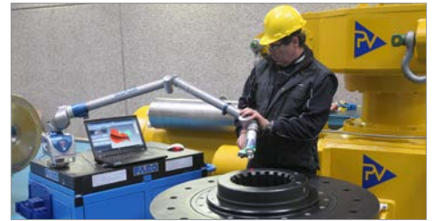
Reverse Engineering mit einem Arm und Laserscanner
