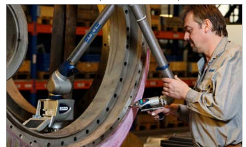
Analyse dimensionnelle à l'aide d'un bras articulé
