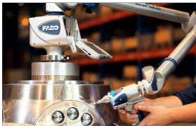
Bras à 7 axes avec « poignet » rotatif
