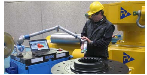
Rétro-conception à l'aide d'un bras combiné à un scanner laser
