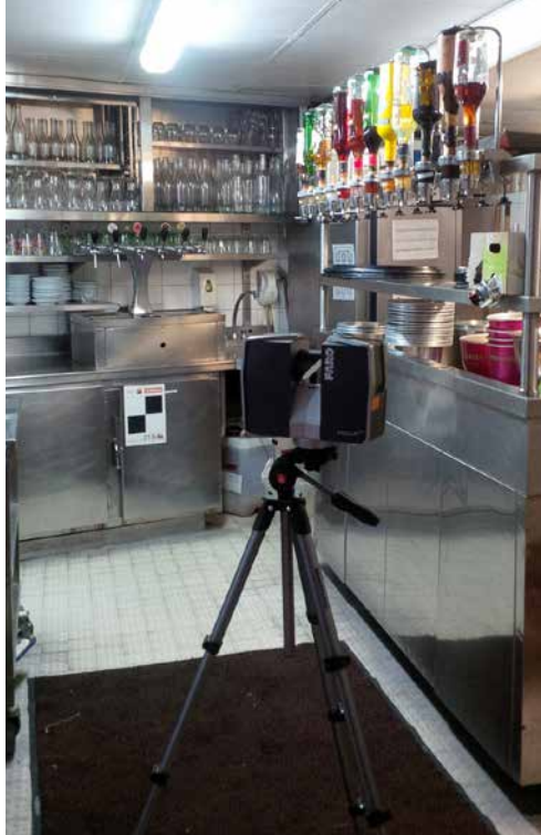
ABM 2 setzt den Laserscanner Focus 3D X 130 von FARO ein, um Vermessungen für Gebäuderenovierungen und die Restaurierung von Beständen des Kulturerbes durchzuführen. Es führt auch auf laufenden Baustellen Vermessungen durch.
