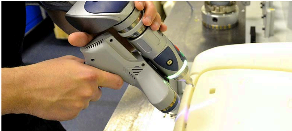
Le ScanArm HD numérise une mousse de siège auto, la vérification peut désormais s'effectuer à partir de l'outillage jusqu'aux produits finis.
