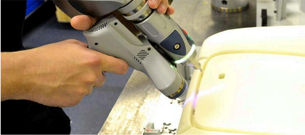
Scannen eines Autositz-Schaumstoffteils mit dem ScanArm HD; Qualitätsprüfung ist jetzt vom Werkzeug bis zum fertigen Produkt möglich.
