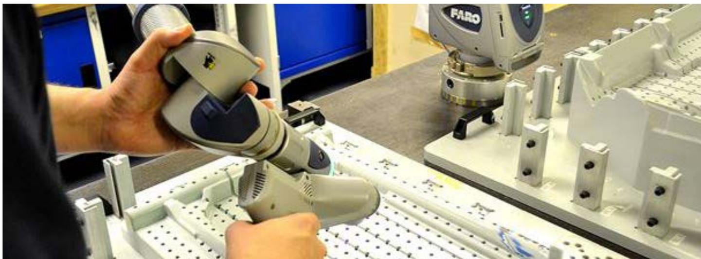
Der ScanArm HD erfasst 500.000 Punkte pro Sekunde, sodass die Inspektion von Schaumstoffbauteilen für Autositze schnell und einfach von der Hand geht.
