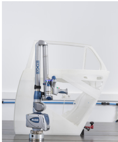
Qualitätsanalyse beim Lasersintern einer Pkw-Tür mit FARO Edge ScanArm HD mit Laser Line Probe HD
