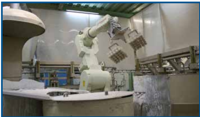
ロストワックス鑄造工程：造形ロボットを使つての鑄型製作
