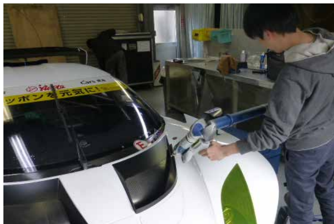
レーシングカーに部品を装着するため、Design ScanArmでスキャン。
