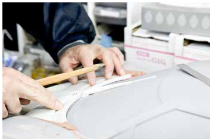
3D造形したパーツを1/5モデルに取り付け、風洞実験を繰り返し、より「安全に速く走る」車造りを目指す。
