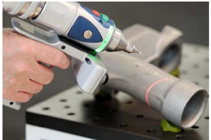
La bande laser capture les données en numérisant 45.000 points par secondes, permettant aux utilisateurs d'accéder rapidement
