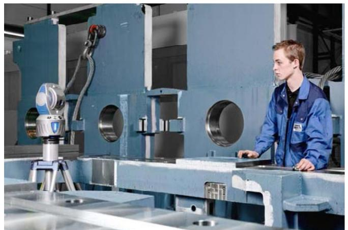
Le fonctionnement du laser tracker est facile à comprendre : Il mesure deux angles et une distance. L'appareil envoie un faisceau laser vers une cible rétro-réfléchissante maintenue contre l'objet à mesurer. La lumière est réfléchiée par la cible, effectue le même chemin en sens inverse pour rentrer dans le laser à la position de départ.
