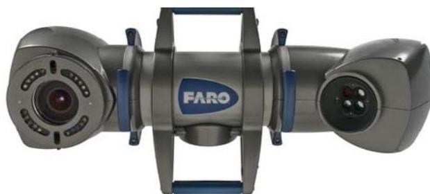
Les systèmes d'imagerie 3D utilisent des projections lumineuses structurées, qui peuvent consister en un motif unique de lignes ou de points. Ces projections sont capturées par une ou plusieurs caméras et, à travers une série de changements dans les projections, les coordonnées 3D peuvent être déterminées pour chaque pixel sur la caméra. Par exemple, un système d'imagerie 3D équipé d'une caméra 4 mégapixels produit 4 millions de points par mesure.
